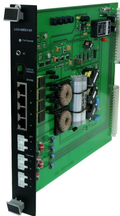
Рисунок 1 Блок линейного ввода LCU-4XEC1-01
